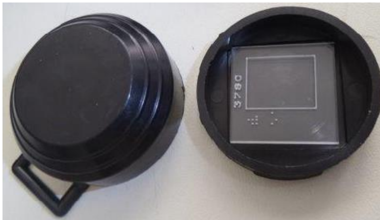
Figura 3: dosimetro di misurazione dell'attività radon indoor
