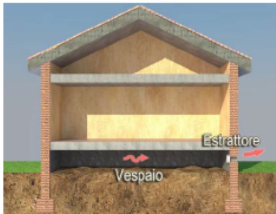
Schema dell'intervento di ventilazione forzata del vespaio.
