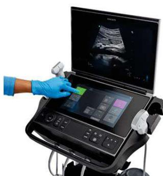
Il pannello operativo è particolarmente adatto ad ambienti di area critica in quanto, oltre ad essere utilizzabile anche con guanti chirurgici, essendo impermeabile con sigillatura elastomerica, è facilmente sanificabile e disinfettabile. Inoltre, i tasti fisici sono realizzati a basso profilo al fine di ridurre al massimo la possibilità di annidamento di agenti patogeni. I trasduttori sono immergibili nei liquidi (IPX7) per una più accurata disinfezione.
